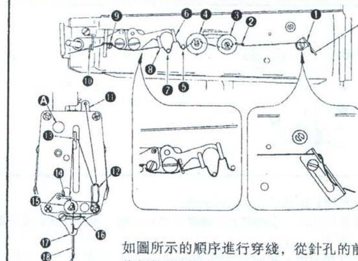
如圖所示的順序進行穿線，從針孔的前側向後側按鬆線螺母A，把線拉出約60~70mm左右。
