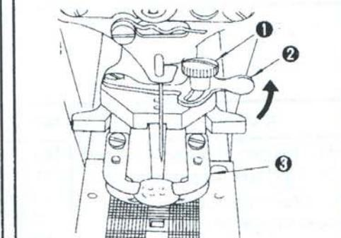
在斷開狀態，擰鬆固定螺絲①，用抓腳打開發杆②打開抓腳③，把鈕扣設定到正確的位置。讓鈕扣容易放進取出，然後擰緊螺絲①。
