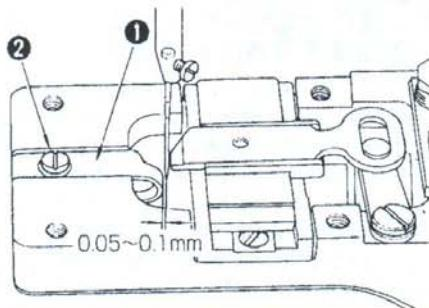
在針杆最下點，擰鬆螺絲②，左右移動針導向器①，把機針和針導向器①的間隙調整為0.05~0.1mm。
