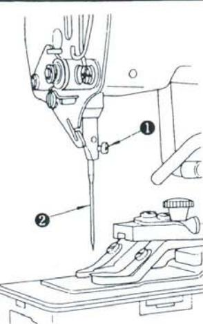
★標準機針為FY-372 使用TQ x 7# 16, FY-373使用TQ x 7# 20機針。
