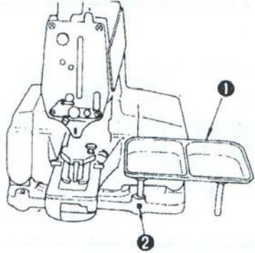
把钮扣盤1插進機座的前部右側的孔上，并把固定螺絲2擰緊固定。如果，右側抓鈕扣不方便的話，請改裝到左側。
