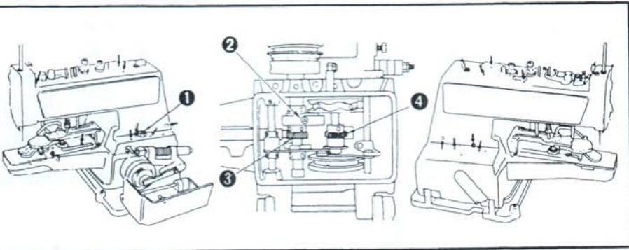
1. 把防震膠墊 1 放到機台上，然後把機頭放到上面，用固定螺絲②、墊片③、螺母④固定好。然後把 S 型挂鈎⑥和鐵連⑦安裝到起動環⑤上。
