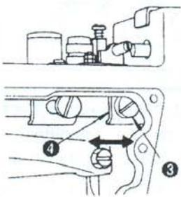
運轉時，把拔針器的方塊②和拔針器①的間隙調整為0.8~1.2mm，不讓拔針器①往壓住機線。調節方法是，擰鬆固定螺絲③，左右移動拔針器活動滑塊④。
