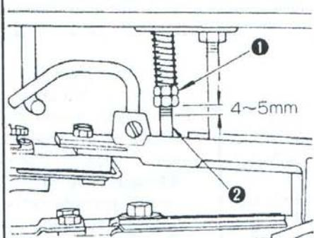
布压脚的压力，以在轉動螺母①和②的下端和壓脚壓力調節杆②的螺絲部間隙為4~5mm時為標準。
