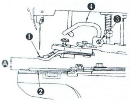
在断开位置，钮扣抓脚①的底面和布压脚下板②上面的间隔A，FY-372的标准为12mm，FY-372的标准为9mm。
