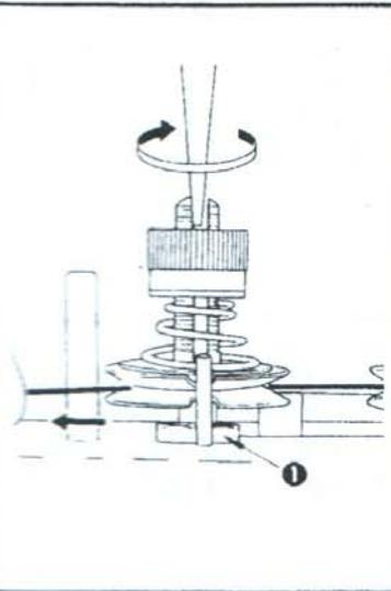
沿箭頭方向拉機線，轉動驅動皮帶輪，有一個第二綫張力盤浮起，機線迅速拔出的點。此時，從針杆上端塊上面到針杆上端的高度為54~56mm時為標準。特別是頻繁發生下列現象時，進行如下調節。擰鬆螺母①，把螺絲刀插入第二綫張力杆，沿箭頭方向轉動的話，針杆高度變低，向相反方向轉動，則變高。
